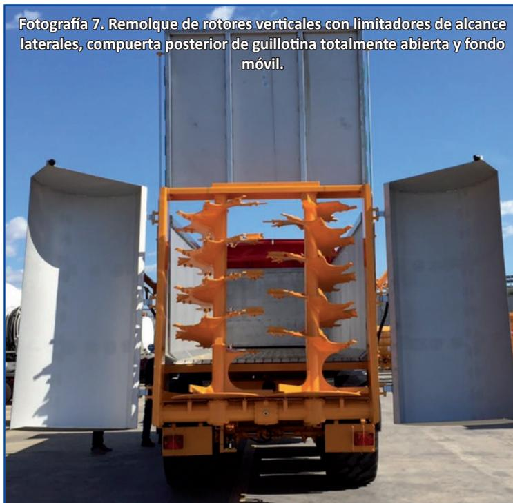
Fotografía 7. Remolque de rotores verticales con limitadores de alcance laterales, compuerta posterior de guillotina totalmente abierta y fondo móvil.
