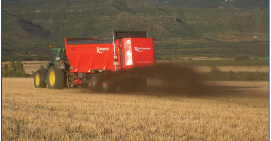
Fotografía 6. Remolque de rotor horizontal.
