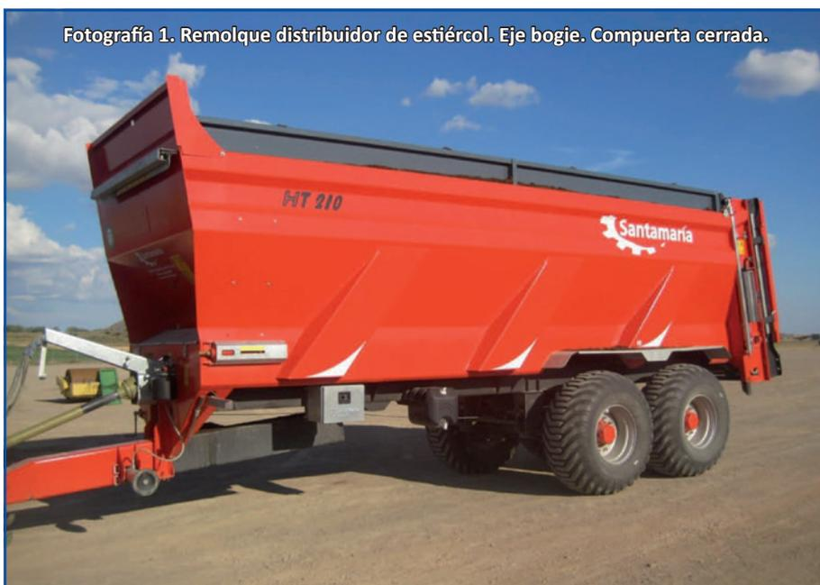
Fotografía 1. Remolque distribuidor de estiércol. Eje bogie. Compuerta cerrada.
