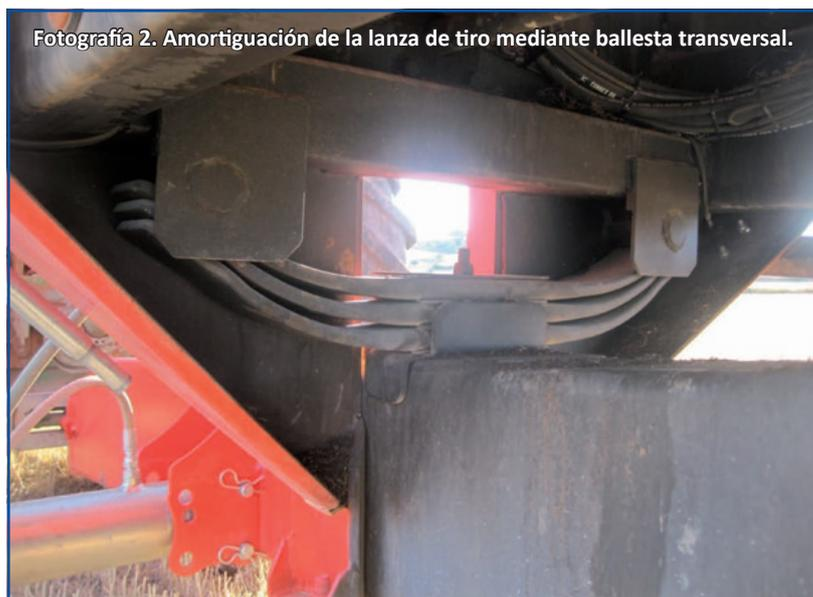
Fotografía 2. Amortiguación de la lanza de tiro mediante ballesta transversal.
