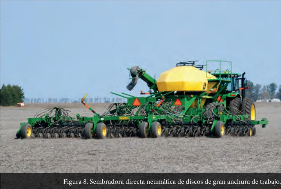
Figura 8. Sembradora directa neumática de discos de gran anchura de trabajo.
