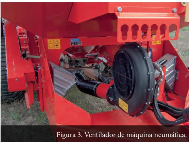
Figura 3. Ventilador de máquina neumática.
