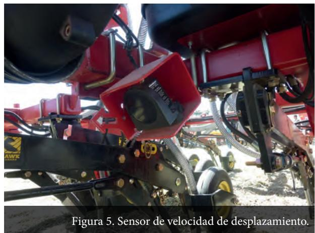
Figura 5. Sensor de velocidad de desplazamiento.
