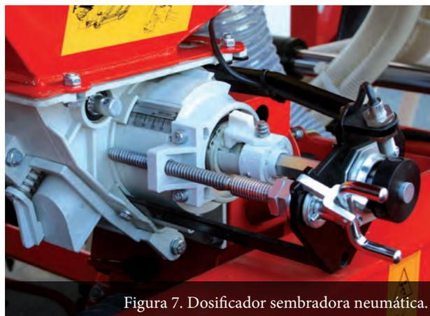
Figura 7. Dosificador sembradora neumática.
