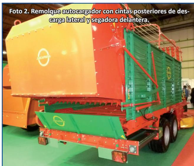
Foto 2. Remolque autocargador con cintas posteriores de descarga lateral y segadora delantera.
