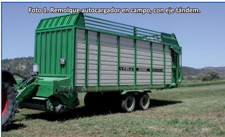
Foto 1. Remolque autocargador en campo, con eje tándem.
