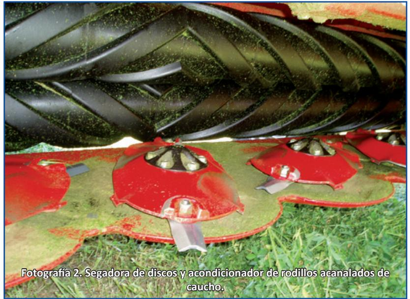
Fotografía 2. Segadora de discos y acondicionador de rodillos acañalados de caucho.
