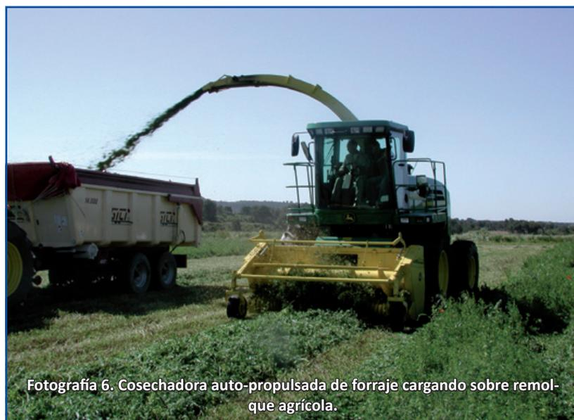
Fotografía 6. Cosechadora auto-propulsada de forraje cargando sobre remolque agrícola.
