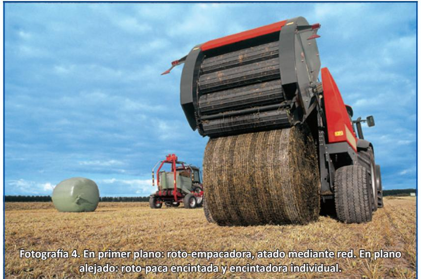
Fotografía 4. En primer plano: roto-empacadora, atado mediante red. En plano alejado: roto-paca encintada y encintadora individual.
