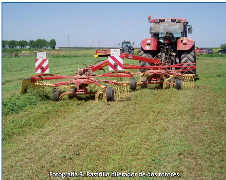
Fotografía 3. Rastrillo hilerador de dos rotores.
