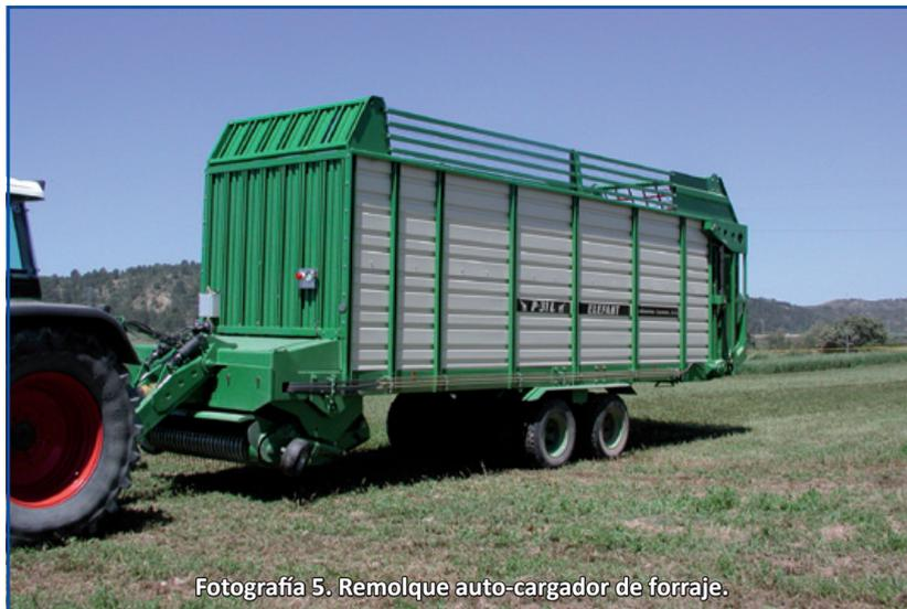
Fotografía 5. Remolque auto-cargador de forraje.
