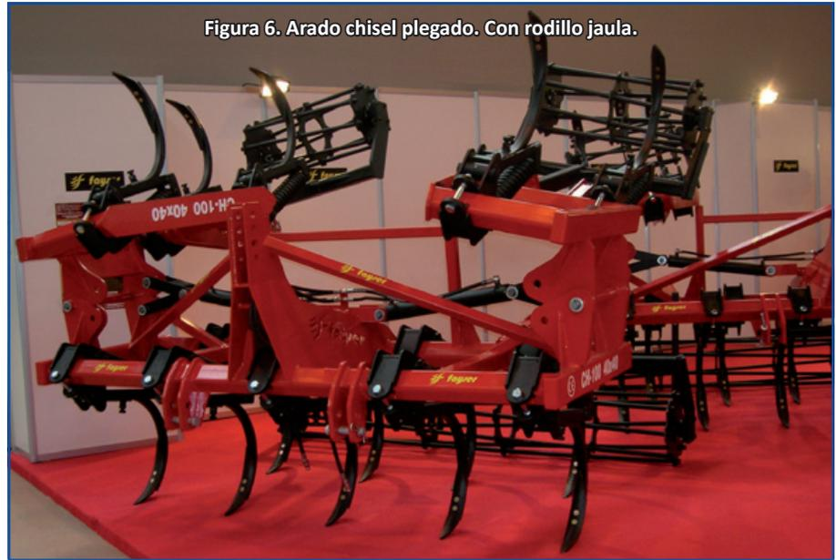
Figura 6. Arado chisel plegado. Con rodillo jaula.
