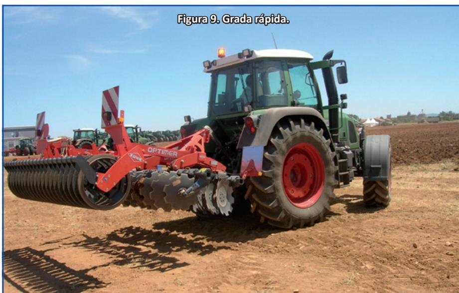
realizar surcos curvos en alguna zona del mismo. Algunas casas comerciales de gradas de discos fabrican gradas que se pueden configurar para trabajo en X o para trabajo en V, adaptándose a las condiciones óptimas. En el caso de anchuras de trabajo mayores a las de circulación por vía pública, al igual que los chisel, se disponen de mecanismos de plegado para poder realizar este transporte sin problema.
