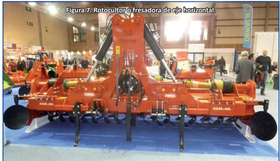
Figura 7. Rotocultivo o fresadora de eje horizontal.
