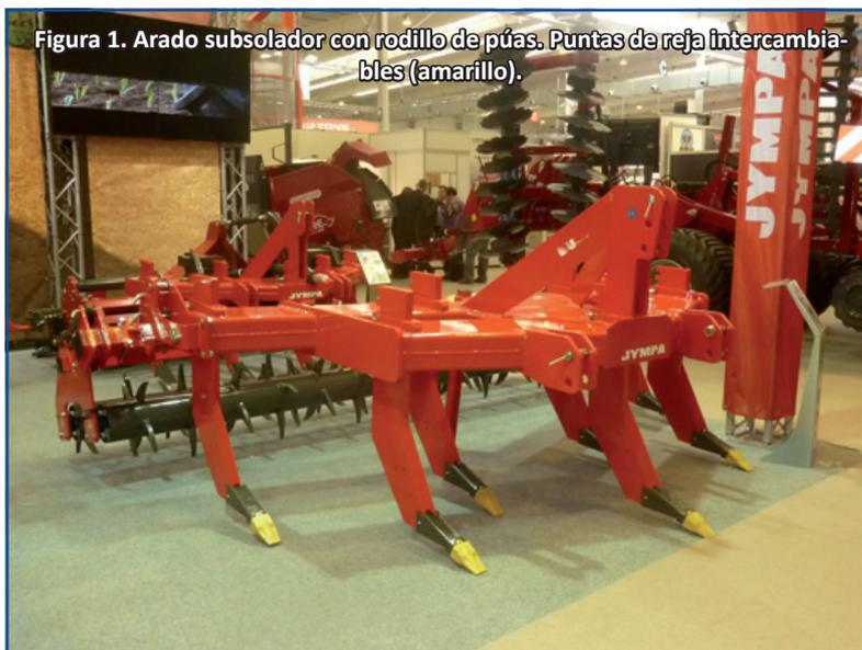
Figura 1. Arado subsolador con rodillo de púas. Puntas de reja intercambiables (amarillo).
