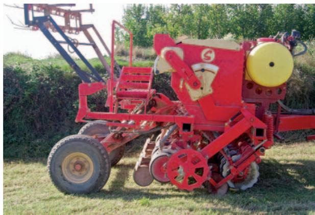
**Figura 2. Disco abre surco escamoteado y rueda control de profundidad.**
