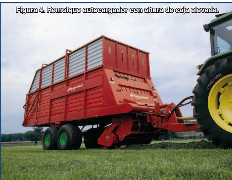
Figura 4. Remolque autocargador con altura de caja elevada.
