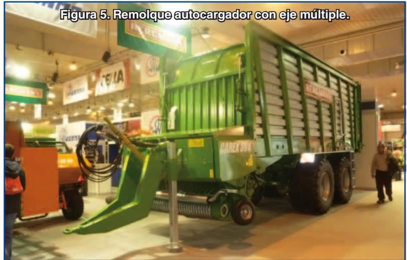
Figura 5. Remolque autocargador con eje múltiple.
