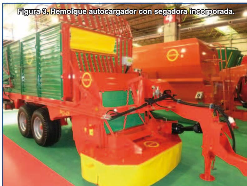
Figura 3. Remolque autocargador con segadora incorporada.
