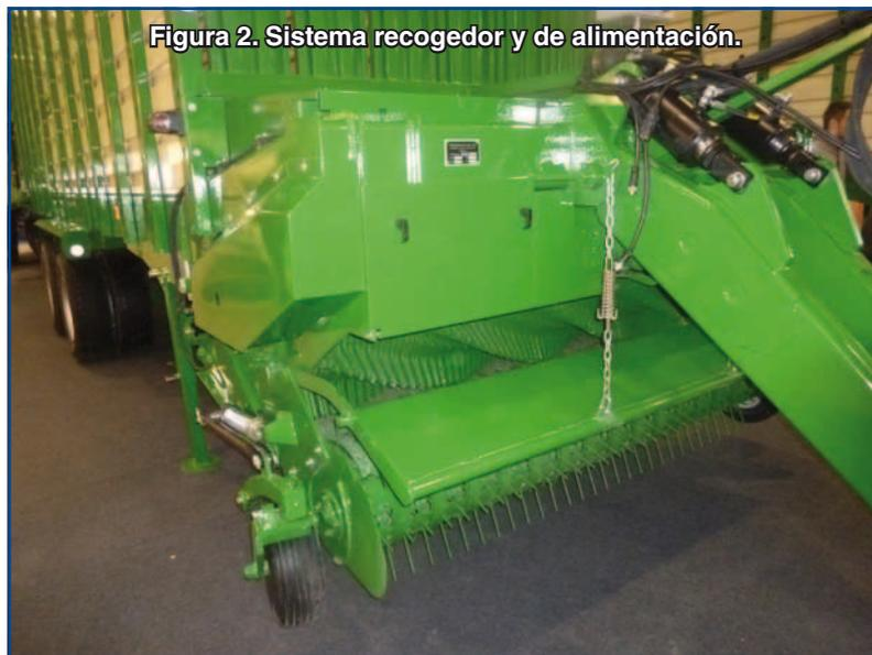
Figura 2. Sistema recogedor y de alimentación.
