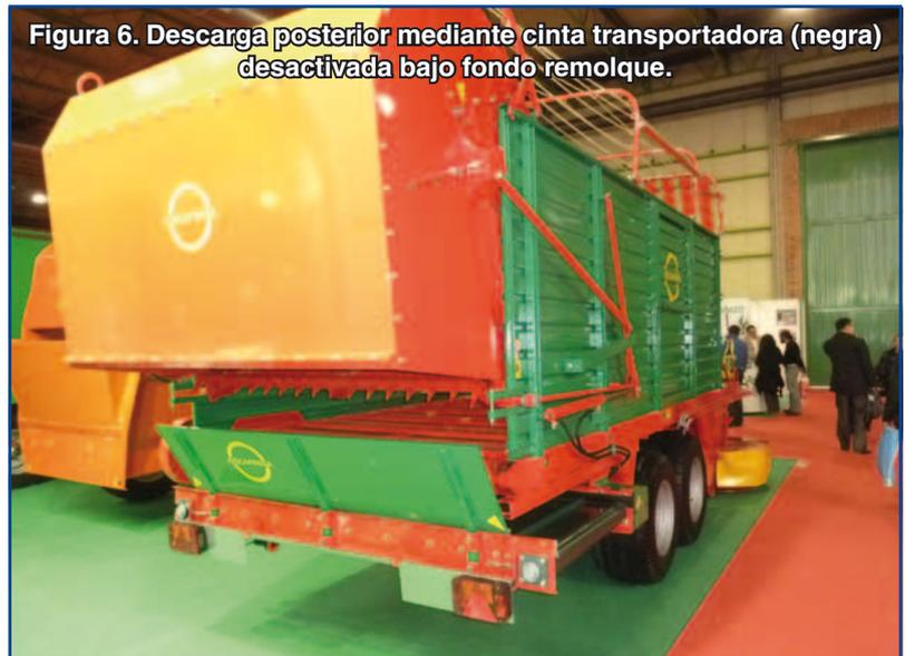
Figura 6. Descarga posterior mediante cinta transportadora (negra) desactivada bajo fondo remolque.
