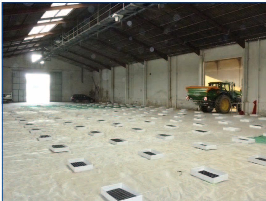
Foto 2. Realización del ensayo de distribución superficial de abono.
