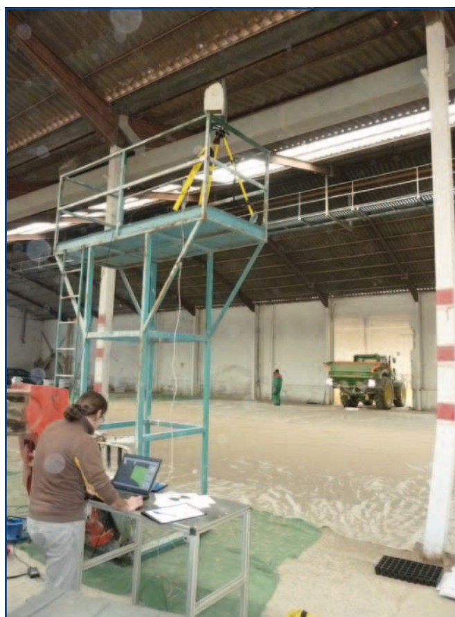
Foto 1. Láser escáner 3D en posición de trabajo durante el ensayo de la abonadora.
