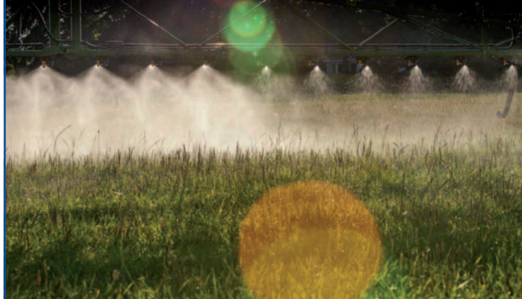
Foto 8. Barra trabajando con diferentes tipos de boquillas seleccionadas de forma automática desde cabina.
