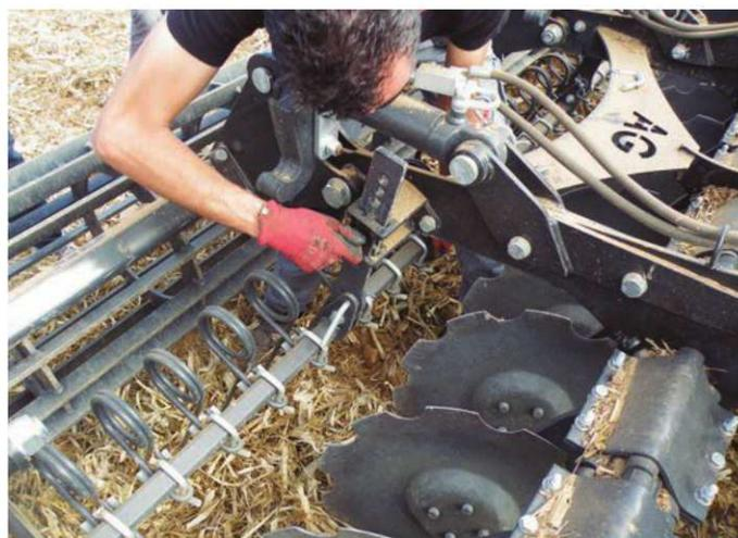
Foto 10 (izda). Cilindros hidráulicos para la regulación de profundidad del apero mediante fijación de la posición del rodillo jaula trasero. Foto 11 (dcha). Regulación de la altura de trabajo de la grada de púas.
