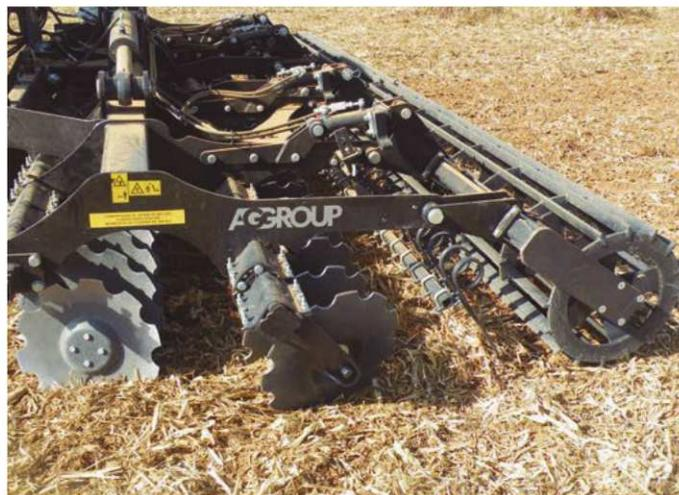
Foto 4 (izda). Anclaje mediante elastómeros del brazo soporte del disco al chasis del apero. Foto 5 (dcha). Inclinación diferenciada de las dos líneas de discos.
