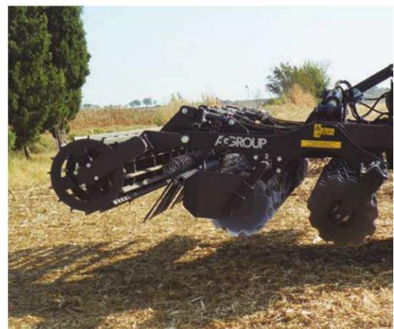
Este tipo de gradas se emplean para realizar labores superficiales, entre 5 y 18 cm de profundidad, principalmente con el objetivo de trituración y mezcla de rastrojo. Se utilizan a elevadas velocidades de trabajo, entre 12 y 15 km/h.
