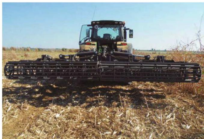
Foto 6 (izda). Corredera con orificios para regulación en altura e inclinación de la grada de púas. Foto 7 (dcha). Vista trasera del rodillo constituido por dos partes plegables.
